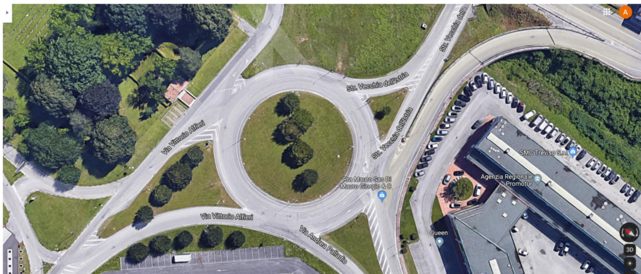
Fig.4 - Vista zenitale rotatoria Alfieri-Palladio; la segnaletica va rivista, inserendo l'obbligo di precedenza a sinistra, accordata cioè ai veicoli che percorrono l'anello giratorio
